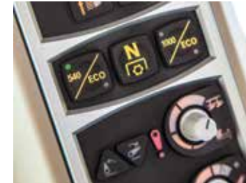
A TLT fordulatszámának elektrohidraulikus kiválasztása
